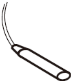
Датчик температуры батареи x1
