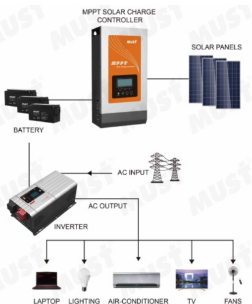
Рисунок 1 Принцип подключения солнечного контроллера Must PC1800F
