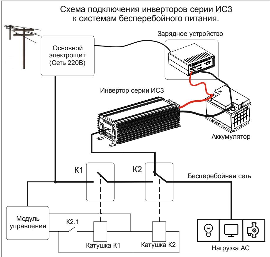
Схема подключения инверторов серии ИС3 к системам бесперебойного питания
