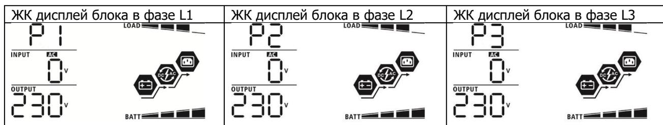
Шаг 4. Включите все автоматические выключатели перем. тока в линейных проводах входа перем. тока. Если обнаружено соединение переменного тока и три фазы соответствуют настройкам блока, система функционирует в штатном режиме. В противном случае начнет мигать значок и блоки не будут функционировать в режиме работы от линии.
