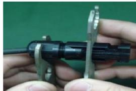
**Шаг 4.** Проверьте правильность полярности кабеля, соединяющего фотоэлектрические модули и входные фотоэлектрические разъемы. Затем присоедините положительную клемму (+) соединительного кабеля к положительной клемме (+) входного фотоэлектрического разъема. Присоедините отрицательную клемму (-) соединительного кабеля к отрицательной клемме (-) входного фотоэлектрического разъема.
