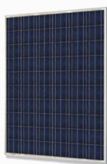
Солнечные модули Delta серии SM изготавливается из высокоэффективных солнечных элементов категории качества Grade A, что гарантирует высокую производительность, долговечность и надёжность. Прочность модуля обеспечивается применением закалённого стекла и рамы из алюминиевого анодированного профиля (с дренажными отверстиями). Жесткая конструкция предотвращает деформацию модуля в экстремальных погодных условиях.
