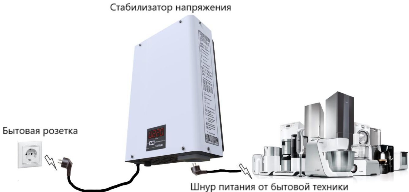
Рисунок 6. Подключение стабилизатора к сети
