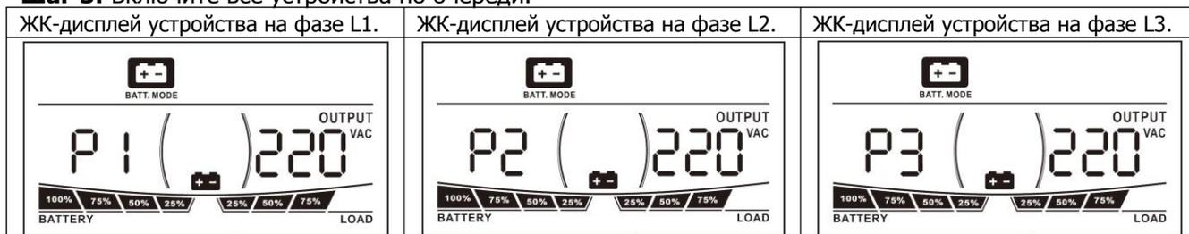
**Шаг 4:** Замкните все прерыватели АС на линейных проводах входа АС. Если есть подключение АС, и три фазы совпадают с настройками устройства, то они будут работать нормально. Если последовательность не совпадает, они не будут работать в линейном режиме. Необходимо поменять провода P2 и P3 или настройки P2 и P3.
