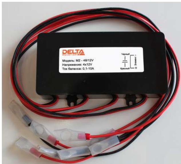
Аккумуляторный балансир M2-48/12V используется для группы батарей, соединенных последовательно.
