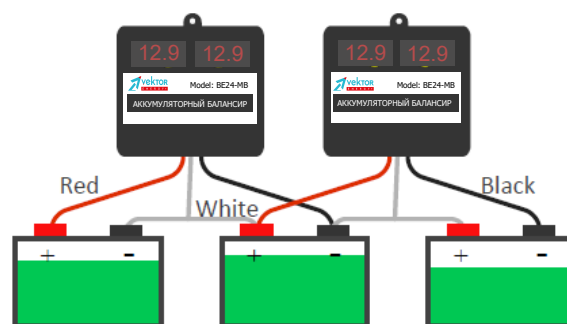
рис. 3 Банк батарей на 36В из 3-х АКБ
